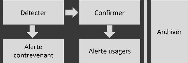
La détection de contresens est effectuée avec des radars permettant de suivre la trajectoire de l'ensemble des véhicules jusqu'à 300m de son lieu d'implantation.
